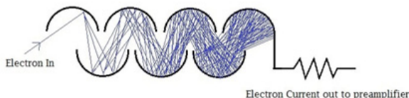
[그림 2-17] Discrete Channel Electron Multiplier
